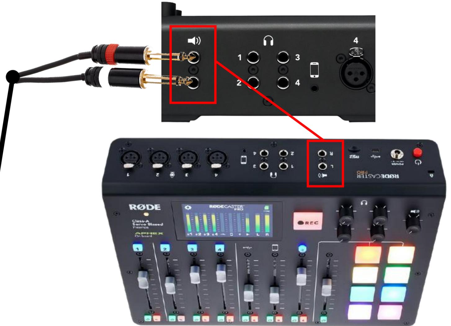
Sur Audacity (Ordinateur) sélectionnez « **RODECaster Pro** » comme sortie audio pour la carte son pour permettre la diffusion d'un enregistrement avec l'enceinte.
